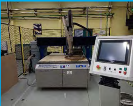
Station de fabrication additive par stratoconception
